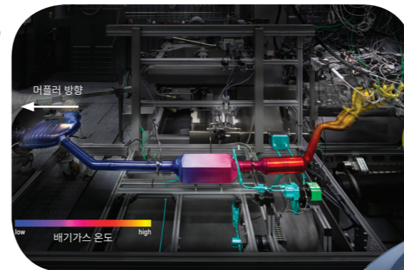
BMW는 자동차 머플러에 열전소자를 장착해, 배기가스 폐열을 전기로 바꿔 엔진 보조전기나 시트 냉난방에 활용하는 기술을 개발하고 있다.
