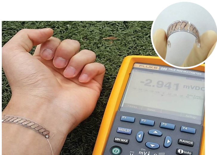
2014년 4월 KAIST 전기 및 전자공학과 조병진 교수 연구팀이 개발한 유연한 열전소자. 비스무트 텔루라이드 Bi 2 Te 3 등을 나노 크기로 만든 뒤 제작한 이 소자는 밴드형으로 손목에 착용하면 체열로부터 전기가 생산되는 것을 확인할 수 있다. 웨어러블 기기의 배터리로 유용하다고 평가받는다.
